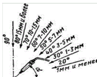
Рисунок 8 - Угол наклона горелки
