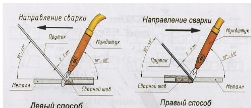
Рисунок 7 - Способы перемещения горелки (способы газовой сварки)
